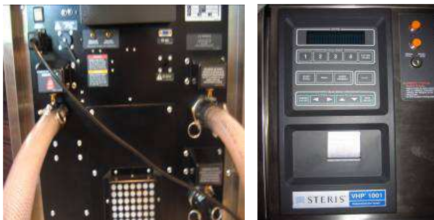
Rys 5. Jednostka bio-dekontaminacyjna STERIS VHP – widok od tyłu. Węże wlotowe/wylotowe. Mikroprocesorowy układ sterujący VHP1001 Eagle oraz drukarka
